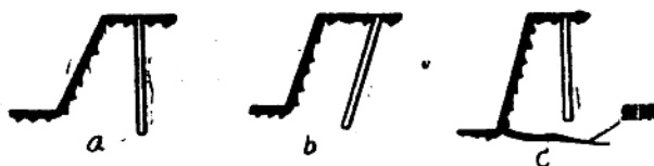
图 3 根据岩石的特点采用不同的炮眼
