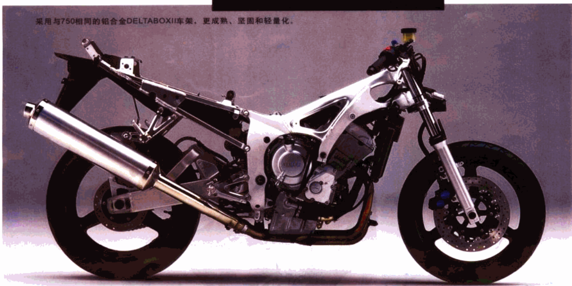
88.2kW的水冷四冲程DOHC 16气门发动机。
