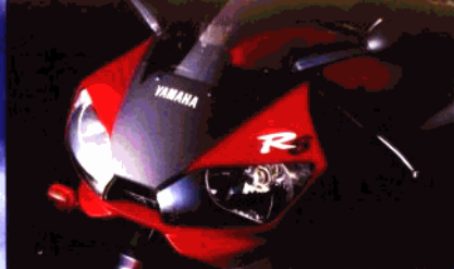
R6在两支前照灯的中央加有直接入风口。
