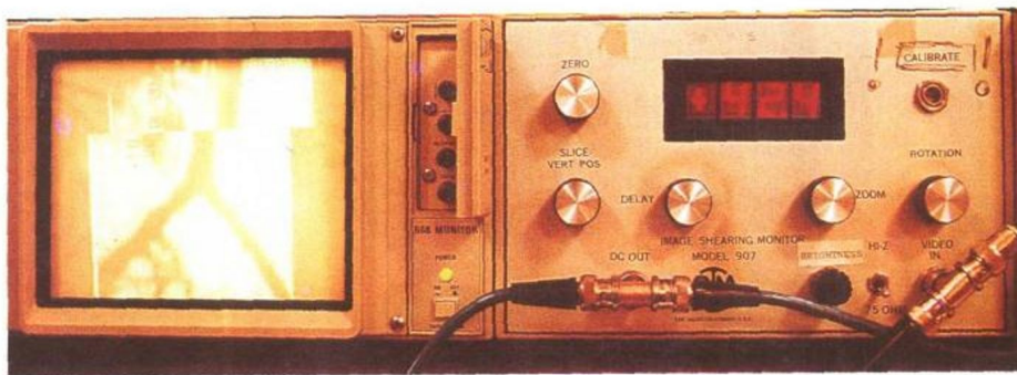
图2 微血管管径电视图象剪切仪外观，左边为剪切的微血管图象
