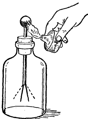
图5 当火焰放到带电的驗电器棒端附近时,箔片就很快合攏。
