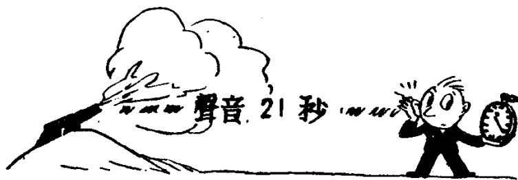
圖 2 如果礮聲需時 21 秒可傳達測量者，二者間的距離可將空氣中的聲速（等於每秒鐘 1,100 呎）乘時間求得。
