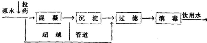
这一工艺流程，在经常的情况下，可以在加入凝聚剂以后，不通过混凝、沉淀（或澄清）直接进入滤池；当原水浊度比较高时，才通过混凝、沉淀。
