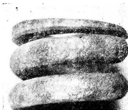
圖3. 因嚴重氧化致表面凹凸不平的彈簧，×0.5
