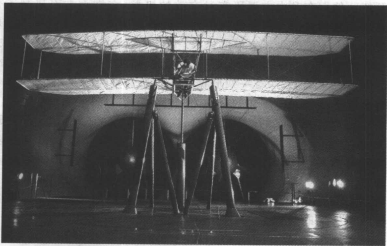
● 莱特兄弟“飞行者”飞机的复制品在NASA风洞里吹风试验
