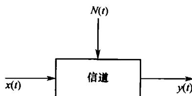
图2-1 最简单的短波信道模型
