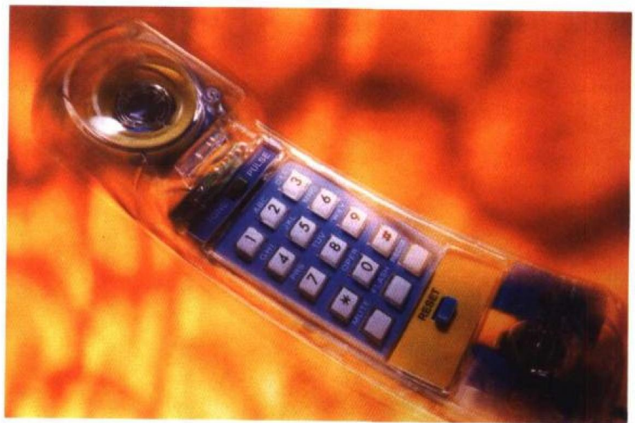
图3.9 透明的电话机。透明，但不是简单地显示内部构造，而是提供了一个很好的系统映像
