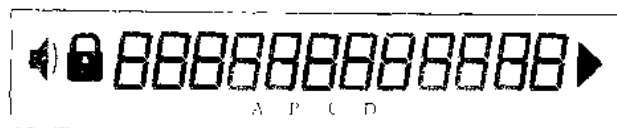
图 2-4 普通寻呼机 LCD 模块全显示
