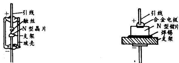
(1) 点接触型二极管的基本结构 (2) 面接触型二极管的基本结构
