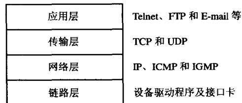
图 1-1 TCP/IP 分层模型
