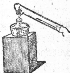
图 7—12 空气是热的不良导体
