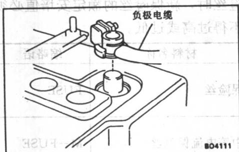
(a) 维修电气设备前, 从蓄电池端子拆下负极电缆。
