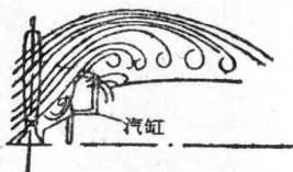
图 2 气冷式发动机上没有达烏念德环所形成的渦流
