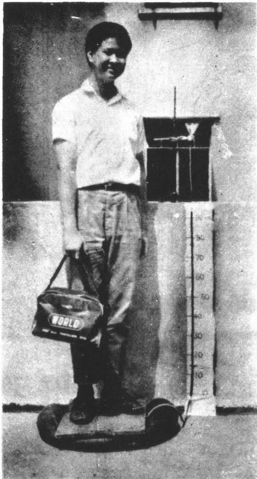
這位同學的體重足有 80 公斤（即 784 牛頓），他站在一個充滿水的輪胎上。水受壓力而升至玻璃管，但僅升高 93 厘米（cm）就停止了（水已用墨水染色以便攝影）。這段水柱的重量極小，但卻能夠和這麼大的體重平衡 (Balance)，初看似乎不易置信。原來這是由於水柱以它底部的壓力毫不減弱地作用在輪胎頂很大的面積上，這個大面積總共所受到的壓力就輕易地和人體的重量平衡了。如果受力面積愈大，則水柱高度就愈小。
