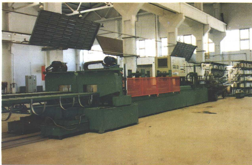
1. 这是中意玻璃钢有限公司引进的 Berplast 拉挤工艺装备， 可以生产各种截面拉挤制品
