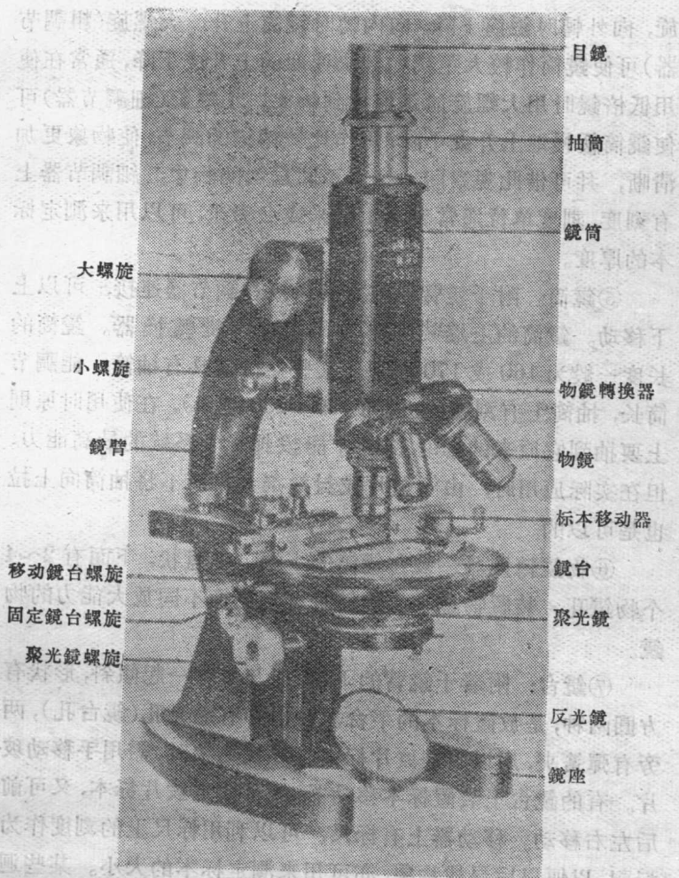
图 1-1 XSW-1 型生物显微镜(仿上海仪器厂)
