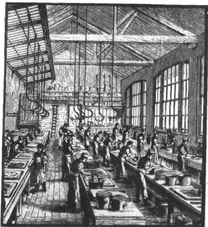
温泽牛顿公司的水彩颜料车间，1889年。颜料是用大理石板和研钵研磨的，从图中可以看出全部操作均用手工进行。
