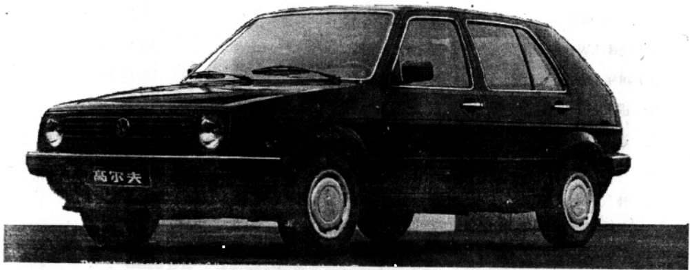
图 1-3 溜背式高尔夫轿车 排量 1.36 升 最大功率 53kW/5200r · min -1
