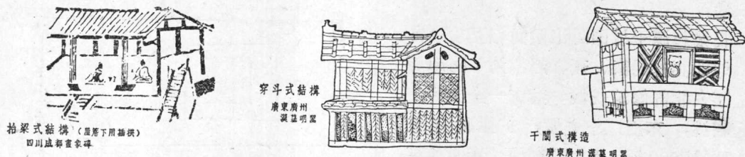
图 1-21 东汉明器中所表示的房屋结构型式
