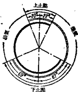
圖5 解放牌汽車發動機 氣體分配相位圖
