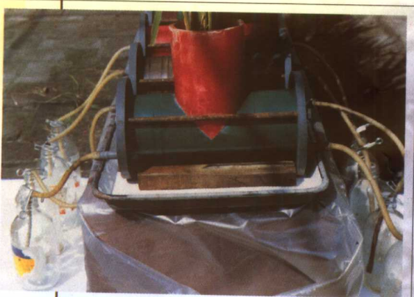
重金属迁移实验装置侧视图
