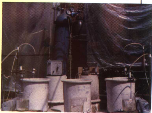
藻类生长试验时的充 \text{O}_2 或 \text{CO}_2 装置
