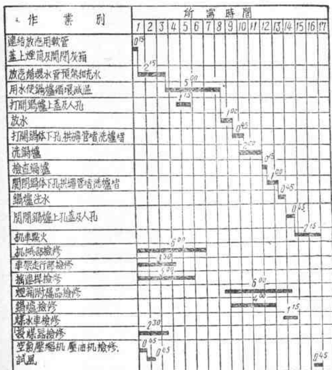
圖 5. J 型機車洗檢調度圖表
