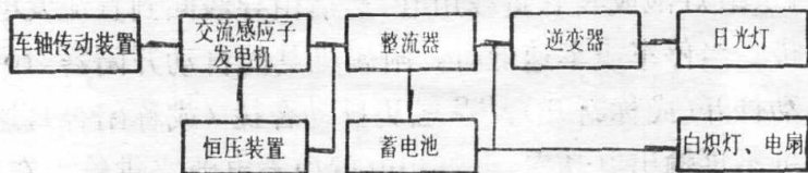
图 1-3 交-交流供电装置的方框图
