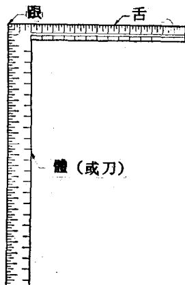
圖 3：鋼直尺用來轉移大樣保持精確尺寸。
