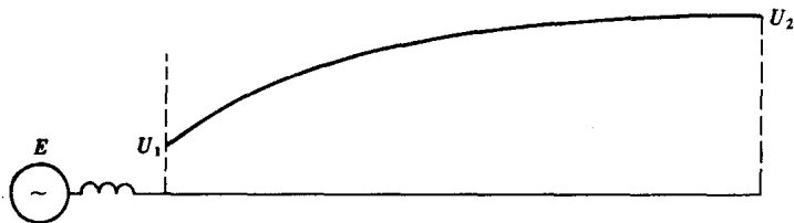
图 10-2 空载长线沿线电压分布
