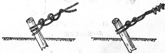
图 15 缆风桩扣的连接法
