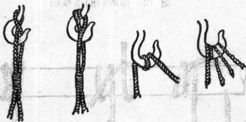
图 16 吊钩结的连接法
