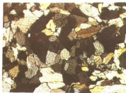
将翡翠切成薄片在高倍偏光显微镜下观察，很容易看见其粒状镶嵌结构及其两组解理近于 90°（正交偏光 400 倍）。
