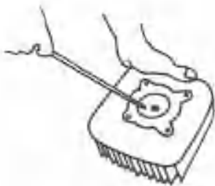
图 1-2 清除气缸盖燃烧室积炭
