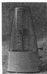
先将摆杆的活动指示标移动至所需要的速度刻度上,然后在节拍装置上调整节拍,摆杆开始摆动后会发出“哒哒”的声音,并报以二拍,三拍或四拍一响的铃声,从而使练习者得到准确的节拍和速度。电子式节拍器工作的原理与机械式大同小异,只是其结构更精密,节拍速度更准确,操作更方便(如图)。
