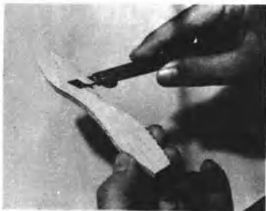
②用鋒利切刀，先把一端削成斜面，再掉轉另一端以相反方向削成另一斜面(參閱附圖)。
