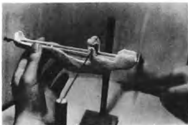
⑭以左手扶着腳的部份，右手用手撥動螺旋槳進行「儲鍊」（留意方向，因放鍊時螺旋槳應把氣流撥向後的，才能令「運動員」滾動）。
