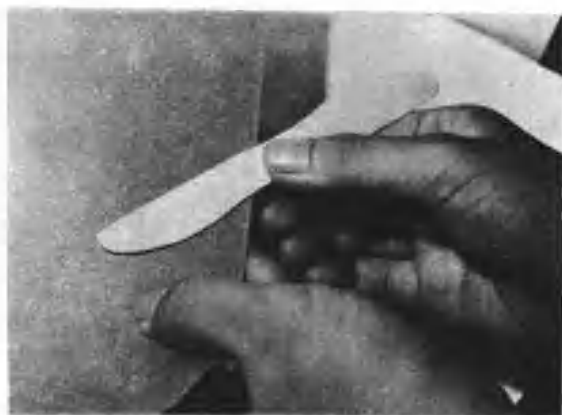
③然後用最幼砂紙小心打磨，要使槩之兩端重量平衡而又光滑。
