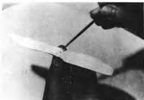
④用尖銼在中心處鑽一小孔備用。
