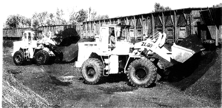
19. 迁安县搬运装卸公司装载机正在捣煤
