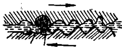
图 1—2 机械磨损的原理
