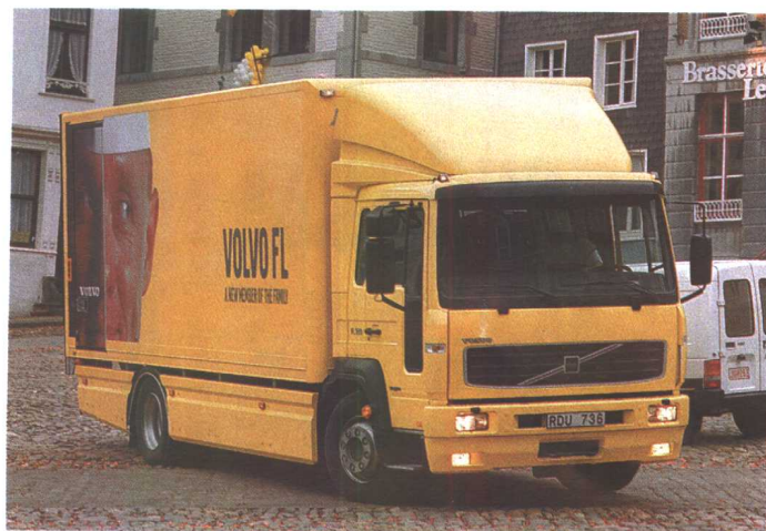
总重量11吨至18吨的新型沃尔沃FL 6，2000年春天开始使用符合欧洲3号排放标准的发动机。
