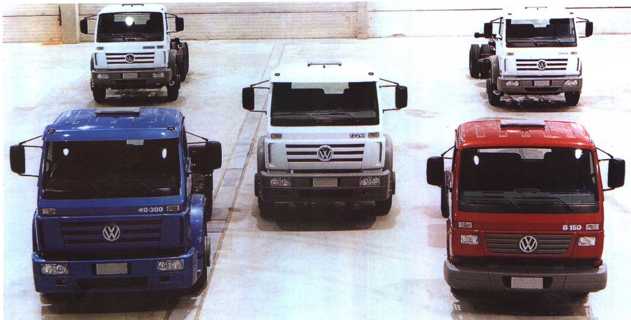
大众2000系列：从总重量8吨的单体载货车到40吨300马力的鞍式牵引车。
