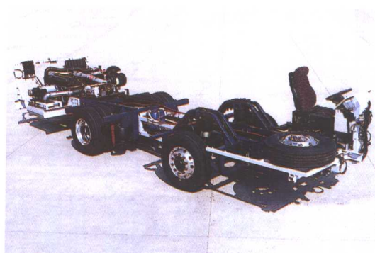
通用的平台:新的以模块构成的梅赛德斯底盘OC 500,用于旅行客车和长途客车。
