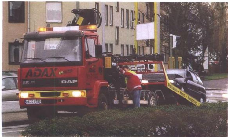
达夫55.210, 总重量13吨至15吨, 牵引量24吨。
