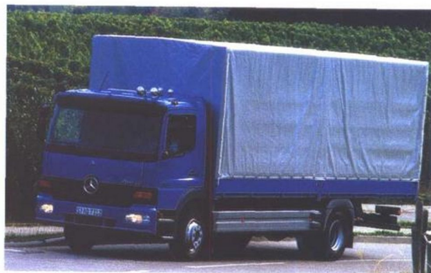
四缸发动机，12吨：亚特格1217由170马力四缸发动机推动。
