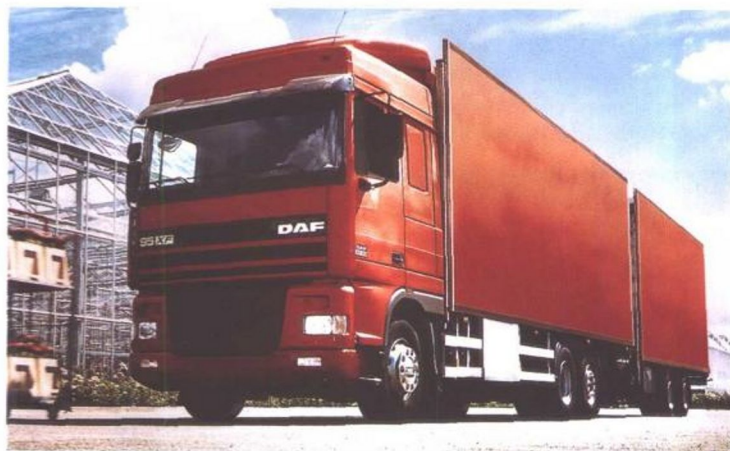
达夫95 XF 430太空出租车 (Spacecab)，6×2，串连悬杆，428马力。
