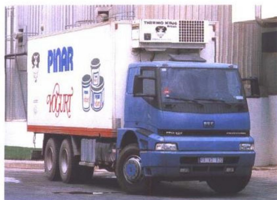
PRO 822, 6 × 2三轴车, 有一安装了双轮胎的后从动轴, 214马力。
