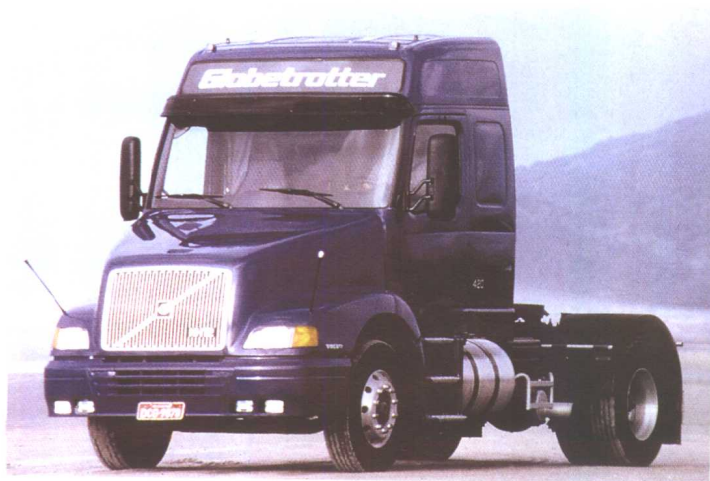
沃尔沃长头汽车NH 12以FH 12为基础，驾驶室后移。
