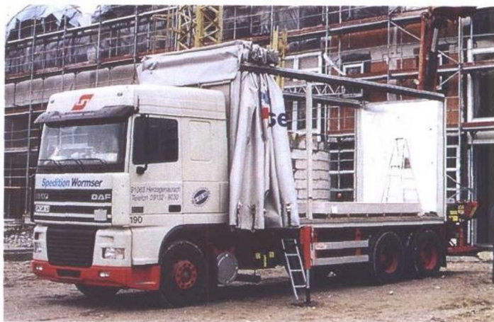
达夫95 XF太空出租车，6×4，车尾有装卸起重装置，381马力至530马力。
