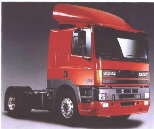
达夫85 CF 430，鞍式牵引车，最大牵引量44吨，428马力。
