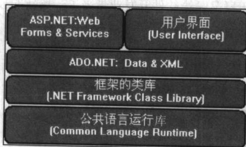
图 1-1 .NET 框架组成结构
