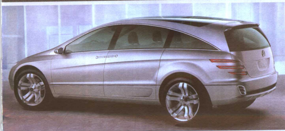
梅赛德斯幻想GST(Mercedes Vision GST)。GST是豪华运动旅行车的缩写——是由豪华越野车、轿车和旅行车构成的混合车型。由于玻璃天窗很大，车内光线充足。可容纳6人。梅赛德斯拟从2005年起以下代M级为基础，批量生产这款长5.15米的全轮驱动旅行车
