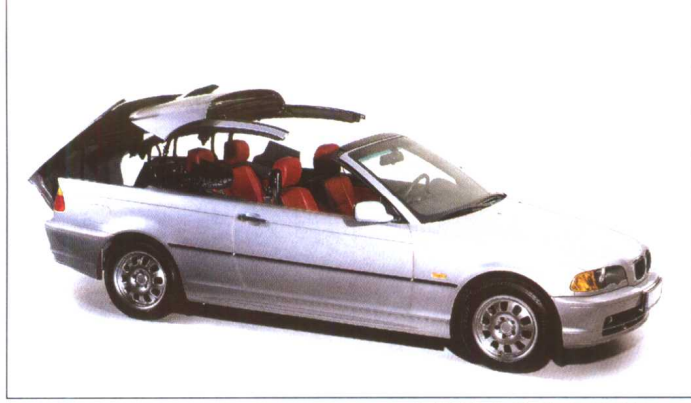
威巴斯托RHT5 (Webasto RHT5)：四座敞篷车带有复杂的可折叠车顶，该系统由5个部分构成
