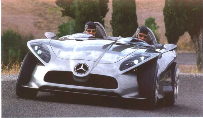
梅赛德斯F 400卡文 (Mercedes F 400 Carving)：这款双座敞篷跑车是为研究制作的。转弯时前轮的外倾角可以变化
