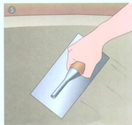
填入岸边凹槽的混凝土
