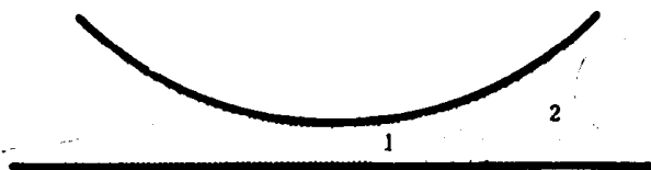
图 1-2 在辊筒与基底之间的压区内流体的劈分
