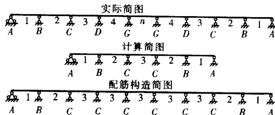
图 1-4 连续梁、板的计算简图
