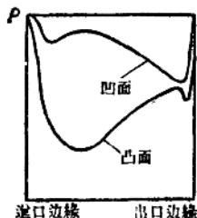
圖 4. 沿氣輪機葉片外形壓力分佈的例子。
