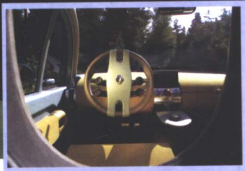
仪表盘的形状非常简洁，但液晶显示屏和像操作杆形状的操作面板从中间向外突出，可以操作车载导航系统及空调等。
