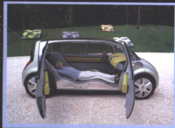
雷诺 Ellypse 的最大特点是，在3.9m的短车体上确保了足以使4位乘客舒适乘坐的空间。车身左侧的车门方面，尽管后门没有中柱，但却采用了既能按普通方式开，也能对开的两种开门结构。
