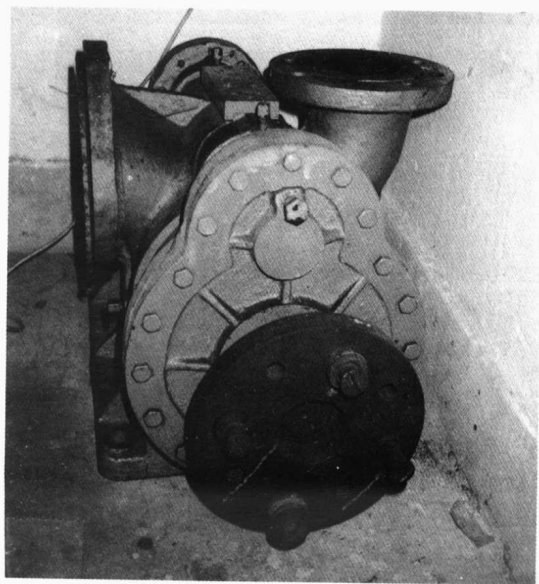
1990年4月11日 汤仲明先生的半 圆凸轮转子泵， 获国家发明专利 CN86105874A
