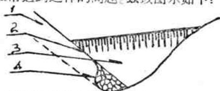
1.陡坡部分必须削坡放缓 2.1:1的边坡 3.陡坡 4.土坝
