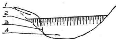
1.土方过大,不宜采用削坡方法 2.1:1的自然边坡 3.土坝 4.此部分因坡度过陡采用浆砌块石或混凝土体填补,放缓坡度
