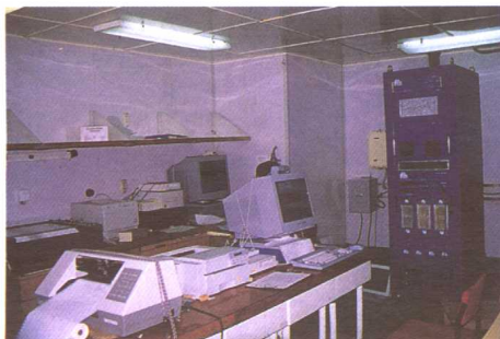
安装在“大洋一号”船上的Sea Beam测深系统
