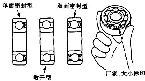
■滚珠轴承洗净之后用压缩空气吹干时不要转动滚珠座圈。因有时滚珠座圈以高于规定的速度旋转时会受到损坏。另外，轴承在组装之前应涂抹机油或润滑脂。
