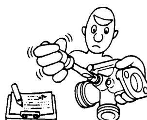
■螺栓、螺母、螺钉一类的紧固是旋入之后,按规定的紧固力矩从大直径到小直径、从内侧到外侧成对角地拧紧。
