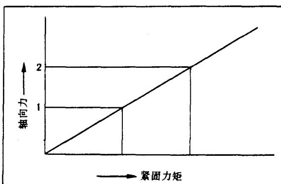
右图表示的是在螺纹部粘附着油脂类时的摩擦系数( $\mu$ )的一个例子。在紧固力矩和被紧固件的材质等都相同的条件下, $\mu$ 也有很大的不同。施加给无润滑螺纹的紧固力矩的88~92%由支承面及螺纹面的摩擦所消耗,能有效地改变轴向力范围的约为8~12%。若减少摩擦,改变轴向力的比率就会变大。也就是说 $\mu$ 值越低,轴向力越高。因此,即使是同样的紧固力矩,轴向力也是不同的。
