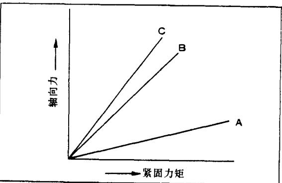
紧固力矩的单位采用 N·m。1 N·m 的力矩表示在1m 长度的扳手上加有1 N 力的力矩。
