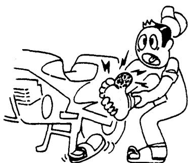
**注意**发动机刚停止工作时,发动机、消声器等很热,注意不要赤手接触,以免造成烫伤。在维修作业时应穿长袖工作服、带好手套。
