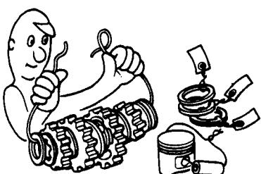
■零件分解检查后,在测定之前应清洗干净并用压缩空气除去洗涤油。组装时应在滑动面上涂抹机油。
