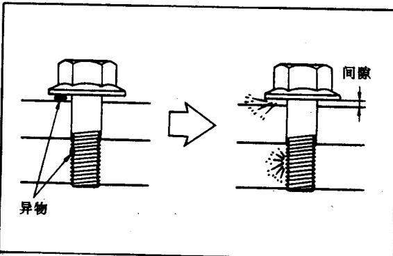
在组装螺纹时，螺牙及螺栓的支承面上若粘附着灰尘、异物等，即使以正规的力矩紧固也不能充分地提高轴向力。另外，即使是获得了正常的轴向力，但由于使用中的外力作用，异物破坏时或异物陷进被紧固件中时，轴向力会急剧地丧失。即使不被认为会降低轴向力，有时螺栓也会产生自身松弛，因此必须将螺牙及支承面清扫之后再行组装。
