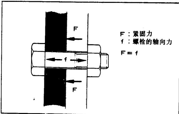
用螺栓紧固所提供的紧固力(初期紧固力)由于时间的推移及使用中的外力与振动,紧固力会降低,这就是螺纹的松弛。
