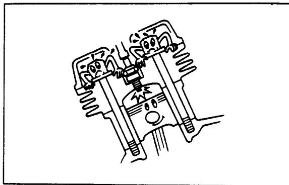
采用一颗螺栓的紧固力相等于螺栓的轴方向的拉伸力。因此,往往有这样的说法:螺栓的紧固力和螺栓的轴向力两者意义相同。
