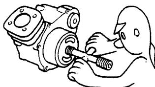
■在将压入的轴承取出时，当出现压力加在轴承滚珠上的拆卸情况时，轴承就不得再使用。
