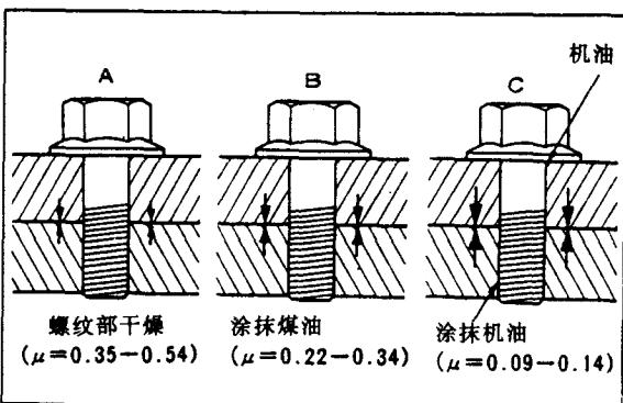
润滑螺纹部及支承面,摩擦力变小,螺纹的锁紧效果就会变差。反之,为了提高螺纹的轴向力、充分获得紧固力,螺纹的松弛也就不容易产生了。
