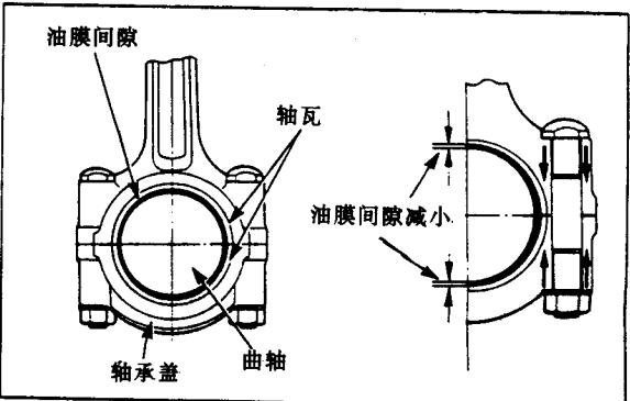
螺纹的适宜紧固力由螺纹的强度、被紧固件的强度、外力的大小等来决定,对特别重要的部位必须正确地紧固。例如,当连杆轴承盖等紧固力比适宜值大时,被紧固件(轴承盖)就会稍微变形,轴瓦的油膜间隙就会比规定值小,严重时甚至会烧伤轴瓦。反之,若轴承盖得不到充分的紧固力,由于急剧的连杆的外力变动,有可能产生螺母、轴承盖在发动机旋转中脱落,导致重大的发动机故障。
