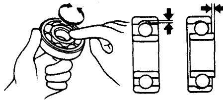
■若是单面密封滚珠轴承则应注意装配方向。若是敞开型或双面密封轴承，安装时应将标有轴承厂家、尺寸的那一面朝向外侧。
