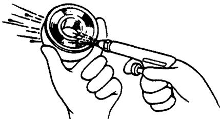
■在装配弹性卡环时，有倒角的一面朝向加有负荷的那一侧。弹性减弱的卡环不能再使用。安装之后应转动弹性卡环，确认其确实安装在卡环槽内。
