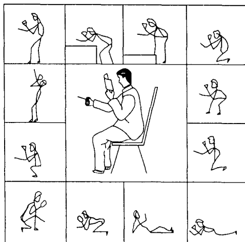
图 2-3 手工电弧焊的各种焊接姿势
