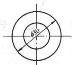
图 1-15 线性尺寸数字的标注方法二
