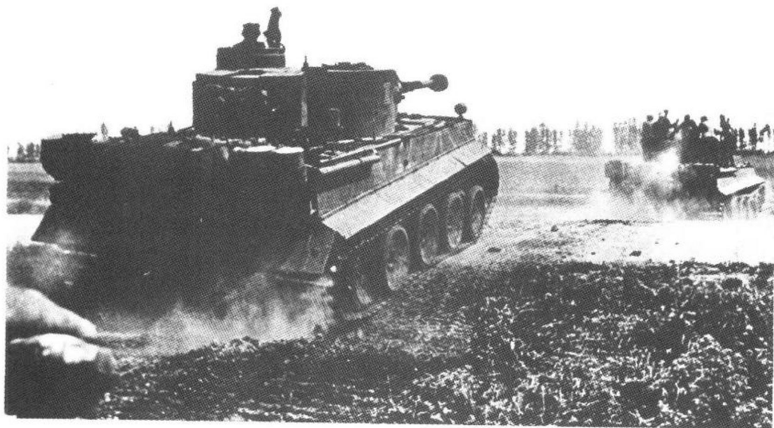
在德国演练中的虎式坦克,其承载装置确保平缓行驶,尽管很重,也能在高低不平的乡间地面上高速前进。请注意这 2 辆坦克传动轮的偏斜度不同。
